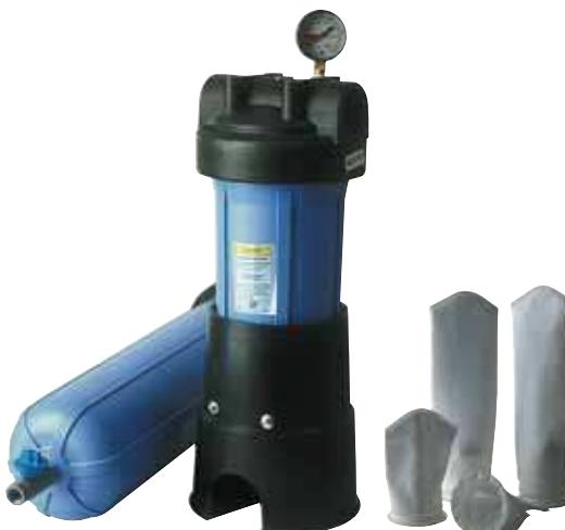
Состоят из легких, коррозионно-стойких колб, изготовленных из прочного полипропилена и мешочных элементов. Данные фильтры предназначены для эксплуатации с водой, кислотами, агрессивными химическими и пищевыми продуктами. Все колбы серии PBH комплектуются манометром, дренажным краном и заглушками (вентиляционной и дренажной).
